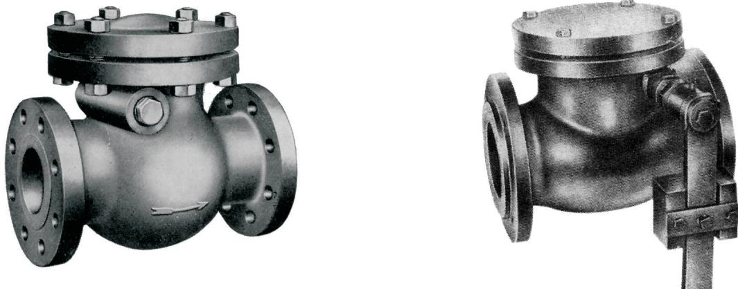
Válvula de retención bridada, para colocar entrebridas serie 150, de clapeta simple, de dirección única, de cierre rápido, cuerpo de fundición gris ASTM A126 Gr. B. Montaje en bronce, asiento roscado al cuerpo, renovable (apto reparación) recubrimiento con pintura epoxi bituminoso, para trabajar con una presión de 10 Kg./Cm.<sup>2</sup> apta para trabajar horizontal ó vertical.
